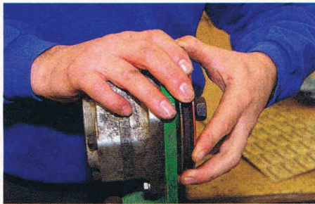
13. Nächster Schritt: durch Hin- und Herziehen überprüft Peter das Lagerspiel der Pumpenantriebswelle
