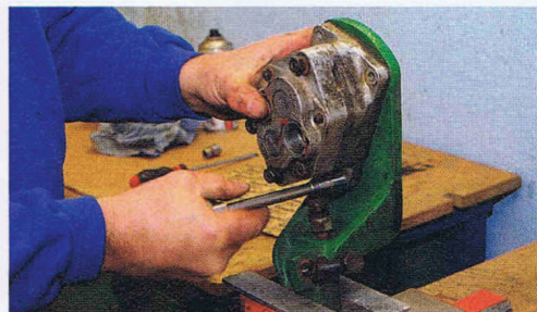
17. Jetzt können die vier Befestigungsschrauben der Hydraulikpumpe aus der Trägerplatte geschraubt werden
