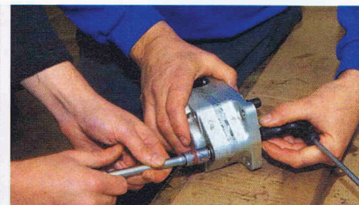
37. Verspannungen vermeiden: Die Schrauben der Hydraulikpumpe ziehen Peter und Andi zuerst „handwarm“ fest, ...
