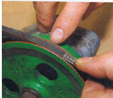
Der Keilriemen greift zu tief in das Scheibenrad und hat zu wenig Kontaktfläche. Er könnte rutschen
