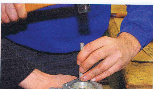
26. Im Schraubstock eingespannt: Mit einem geeigneten Durchtreiber schlägt Peter die Führungshülsen jetzt endgültig aus ihrem Sitz
