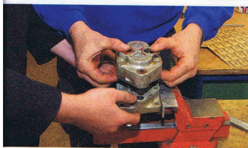
22. Vorsichtig hebt Peter das obere Gehäuse teil ab. Er achtet hier besonders darauf, dass keine Kleinteile aus der Pumpe fallen
