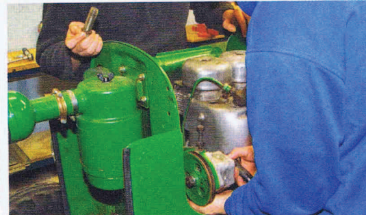
4. Die Hydraulikleitungen sind demontiert und der Keilriemen vom Scheibenrad abgenommen. Jetzt kann Peter die Pumpe herausheben
