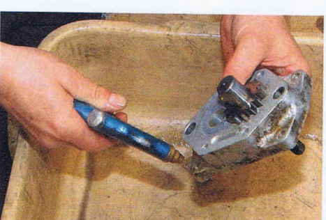
30. Nach dem Waschen folgt das Föhnen. Andi bläst mit Pressluft alle Teile trocken
