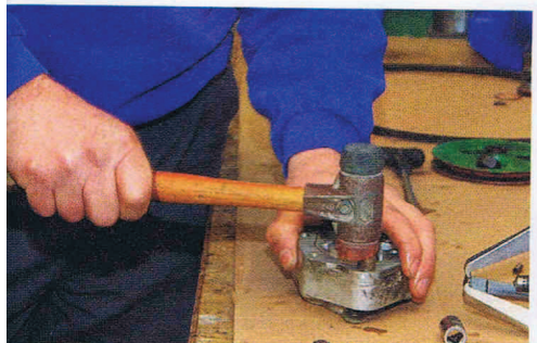
24. Auch die Führungshülsen müssen raus. Mit vorsichtigen Schlägen treibt sie Peter aus ihren Führungen
