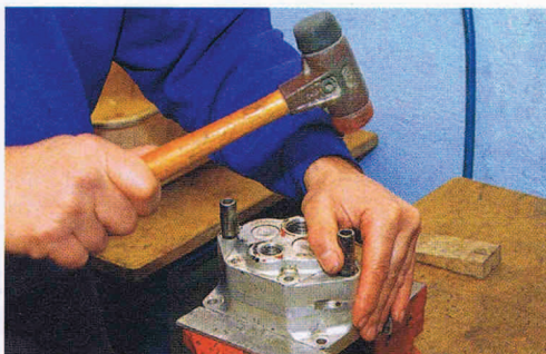
36. Die Führungshülsen werden zuletzt gesetzt. Wenn alles spannungsfrei zusammengebaut wurde, lassen sie sich leicht eintreiben
