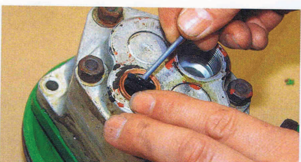
11. Peter zieht den Stöpsel, der wohl bei einer früheren Montage in der Ablaufleitung vergessen worden war, mit einem kleinen Schraubendreher heraus
