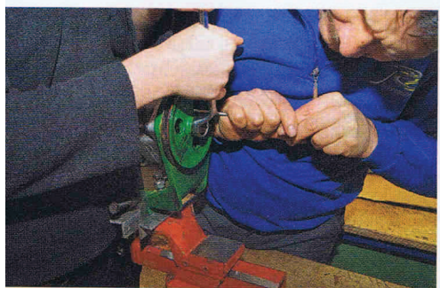
42. Vereinte Kräfte: Peter und Andi ziehen die Zentralmutter an. Auch hier kommt der Drehmomentschlüssel wieder zum Einsatz
