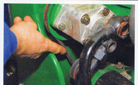
44. ... einen Finger breit durchdrücken lassen. Nun noch die Hohlrauben der Hydraulikleitungen festziehen
