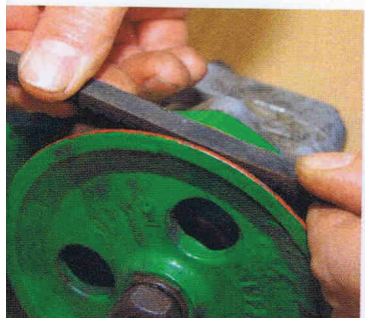
Das wäre ein guter Keilriemen: Die Flanken ragen rund ein bis zwei Millimeter über das Scheibenrad
