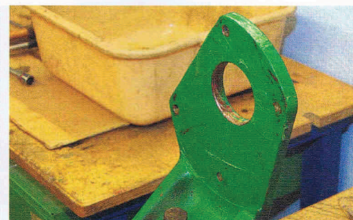
39. Vor der Montage der Hydraulikpumpe auf der Trägerplatte hat Peter diese zum Schutz vor Korrosion mit Fett eingestrichen
