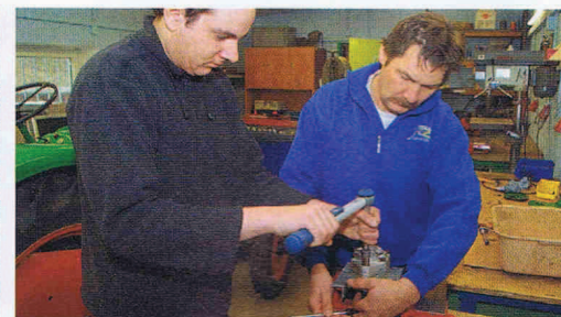
38. ... dann werden sie über Kreuz mit dem Drehmomentschlüssel (Drehmoment beachten!) endgültig festgezogen
