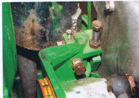
2. Der Spannmechanismus der Hydraulikpumpe kann über drei Schrauben eingestellt werden
