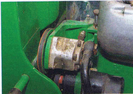
1. Unter Fehler-Verdacht: Die Hydraulikpumpe des Deutz. Gottlob ist sie leicht zugänglich und wohl schnell ausgebaut
