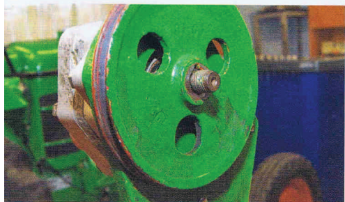
41. Vor dem Anziehen des Scheibenrades kontrolliert Peter, ob der Mitnehmerkeil auch in seiner Nut im Scheibenrad sitzt
