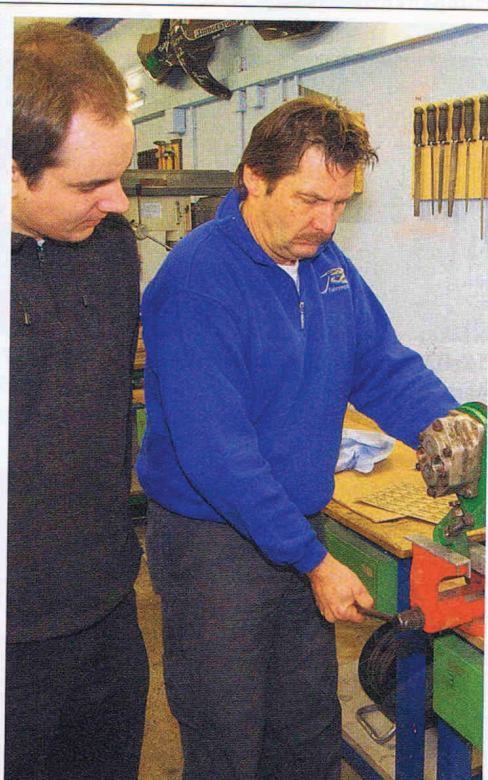
12. Weitere Demontage im Schraubstock: Der vergessene Gummistöpsel könnte zu erhöhtem Verschleiß geführt haben
